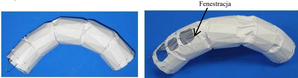
Materiały stentgraftu: politetrafluoroetylen, stal nierdzewna, fluorek poliwinylidenu
